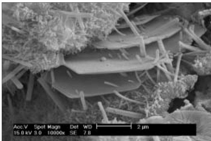
Idratazione del legante a base di cemento Portland di una comune stuccatura
