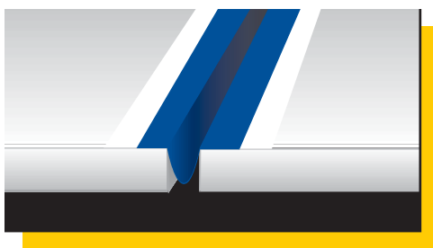
Posizionamento a omega di Mapeband all'interno del giunto di dilatazione
