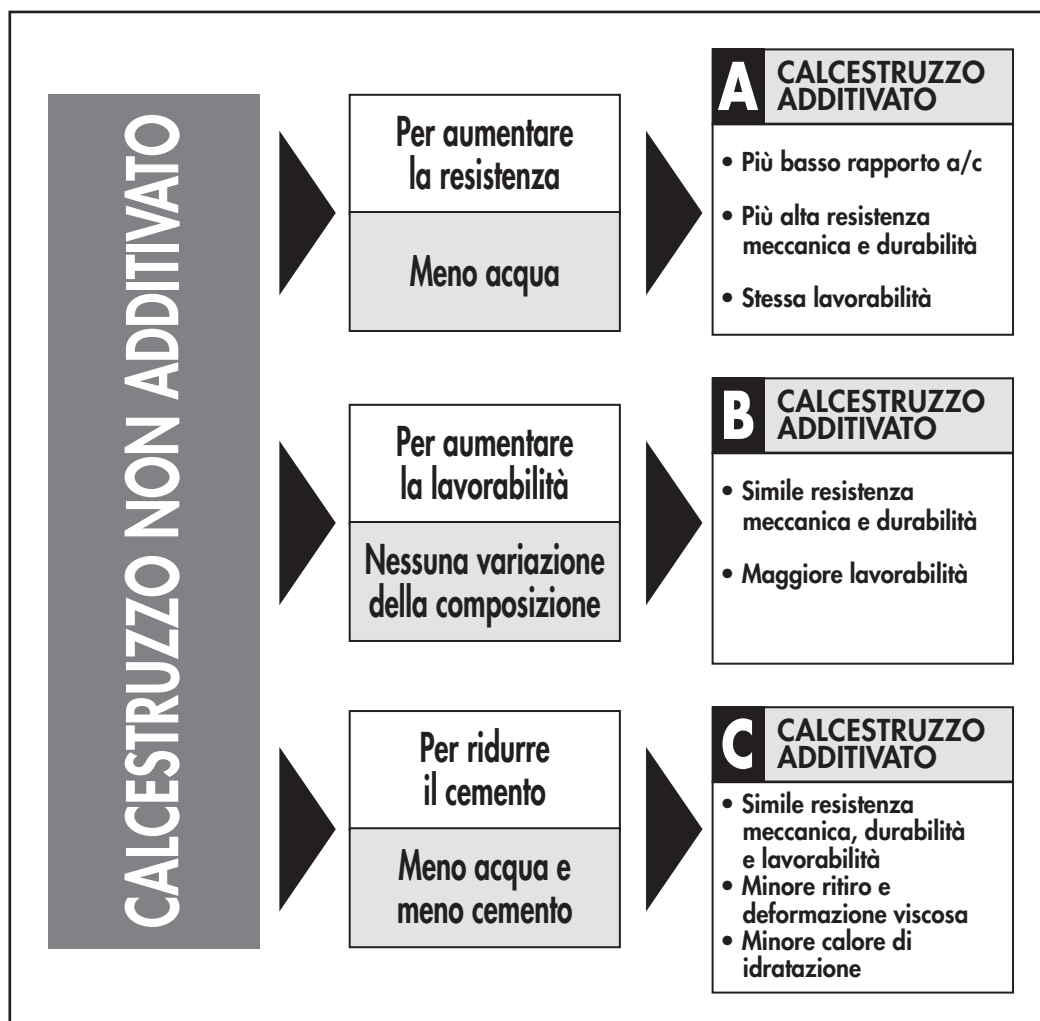
Fig. 2 - Tre diverse modalità di impiego per trarre vantaggio dall'additivo Mapefluid N100
