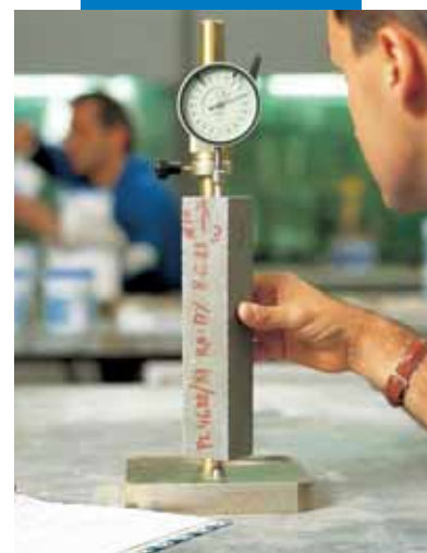
Determinazione dell'espansione contrastata secondo UNI 8147
