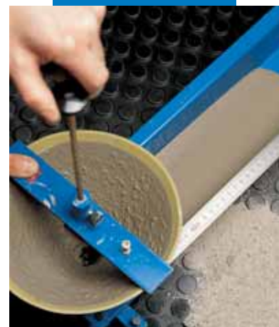
Prova di scorrimento secondo EN 13395-2
